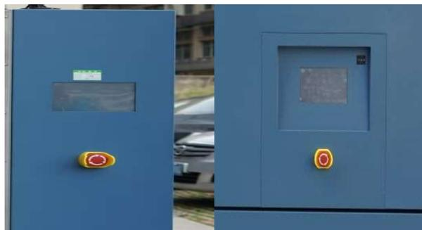
**控制箱及面板：**采用电解板喷塑，颜色为标准色，面板上安装触摸式人机对话界面、急停开关、电源指示灯、USB、数据交换接口、超温保护器等操作指示。
