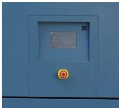
控制箱及面板：采用电解板喷塑，颜色为标准色，面板上安装触摸式人机对话界面、急停开关、电源指示灯、USB、数据交换接口、超温保护器等操作指示。
