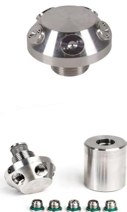
**水喷淋喷头:**细水雾喷头使水在涡流式中通过强力旋转运动，瞬间转化为细水雾高压喷向电池。范围广，水消耗少。
