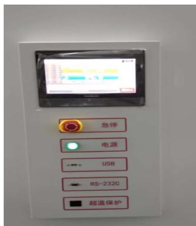
**控制箱及面板：**采用电解板喷塑，颜色为标准色，面板上安装触摸式人机对话界面、急停开关、电源显示灯、USB、数据交换接口、超温保护器等操作指示。
