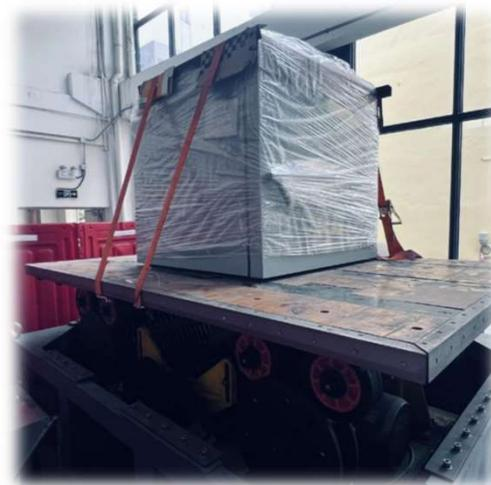
小型设备出货前进行振动测试
