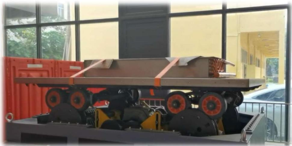
零部件如冷冻蒸发器等安装前进行振动测试
