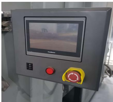
**控制箱及面板：**采用电解板注塑，颜色为标准色，面板上安装触摸式人机对话界面、急停开关、电源显示灯、USB、数据交换接口、超温保护器等操作指示。
