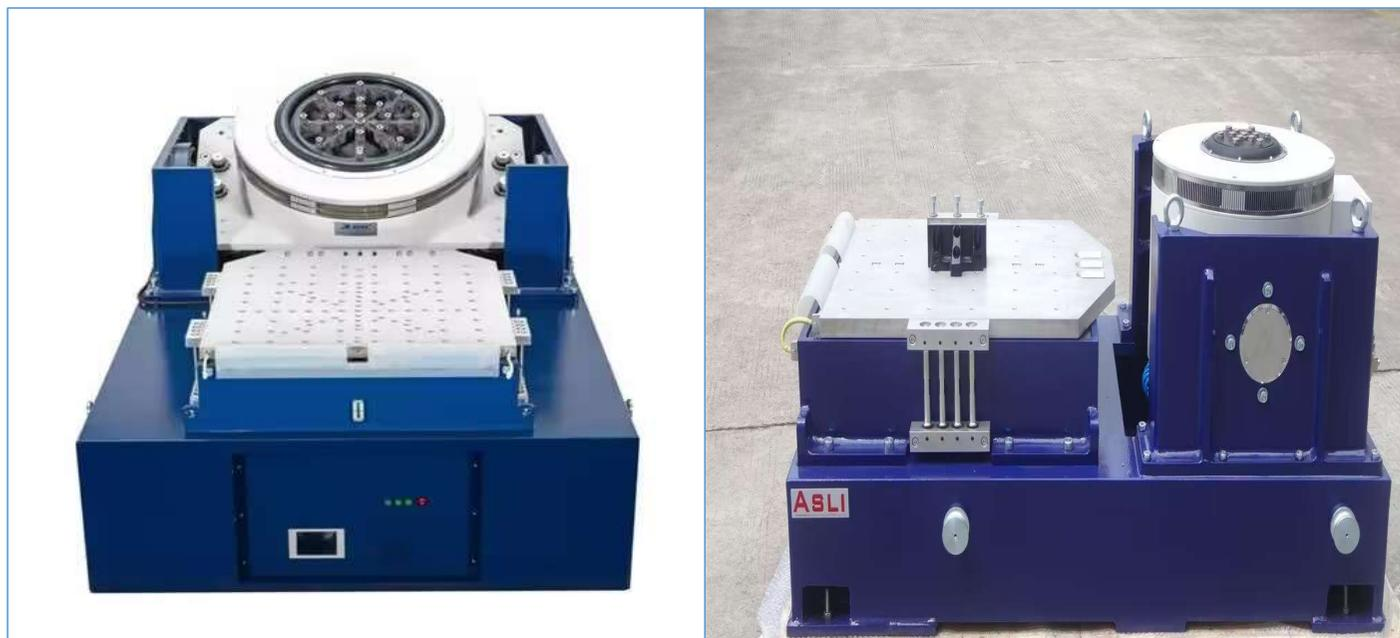
**振动台**又称振动激励器或振动发生器，它是利用电动、电液压、压电或其他原理获得机械振动的装置。可以水平振动，垂直振动。与恒温恒湿箱配合，广泛运用于国防、航天、通讯，电子、汽车、家用电器等行业。
