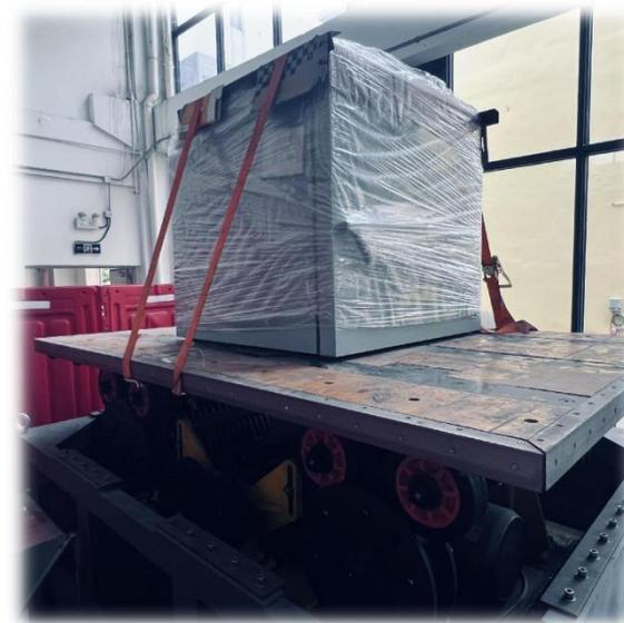
7、小型设备出货前进行振动测试
