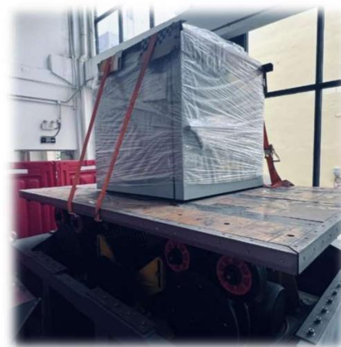
7、小型设备出货前进行振动测试
