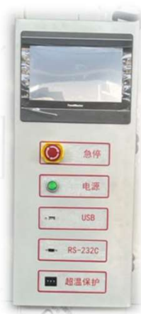
箱体控制面板（急停开关、超温保护，RS-232通讯接口）
