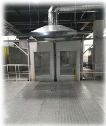
舱外点爆（地坑下沉式）
